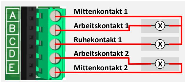
Beispiel 2: Stromlosschaltung von isolierten Gleisabschnitten, hier am Beispiel beim 3-Leiter Gleis. Das Gleissignal GLB muss an den EXT-Anschluss geführt werden.
